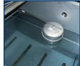
Depósito de agua de proceso con calefacción y control automático del nivel de llenadocontrol
