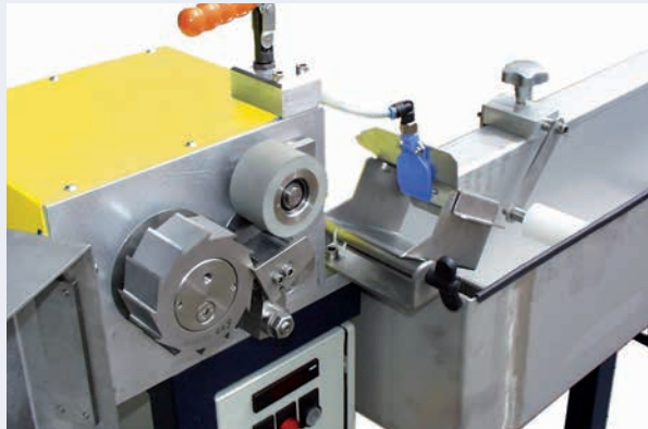
Área de corte con depósitos bajos para un cambio rápido de producto (ips-SG-E 30 Kombi)
