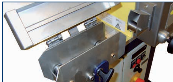
Opcional: ips-SG-E 30 Kombi Desaguado integrado del hilo por succión
