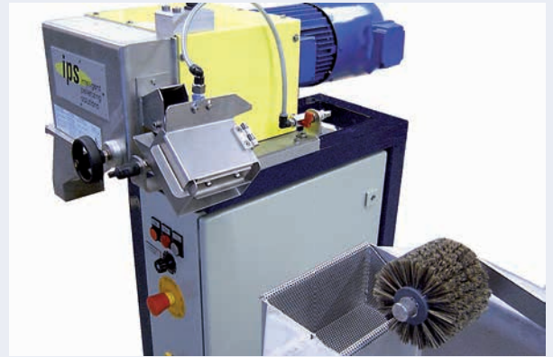
Alimentación de hilos guiada con desaguado de hilos integrado por soplado (ips-SG-E 30 Kombi)
