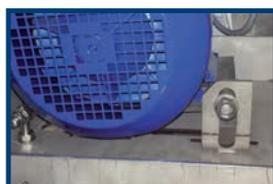
Tensado especialmente sencillo de la correa de transmisión
