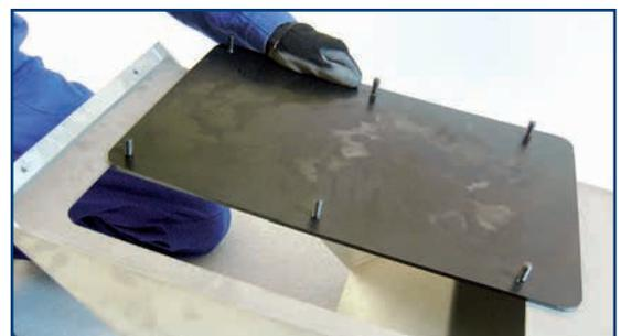
Salida de pellet con placa protectora contra desgaste reemplazable
