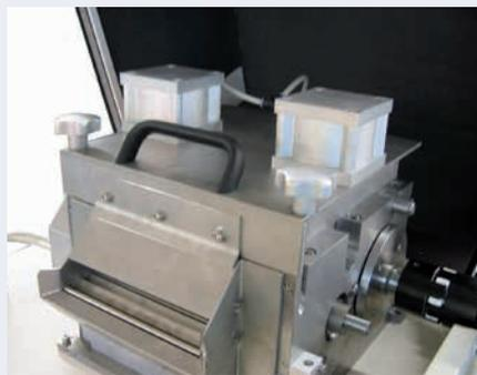
Todos los tamaños tienen dos cilindros neumáticos en el rodillo de alimentación superior para una acción de alimentación óptima.
