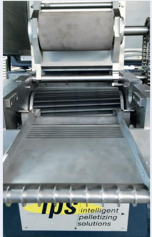
Área de alimentación de los hilos diseñada para facilitar la limpieza
