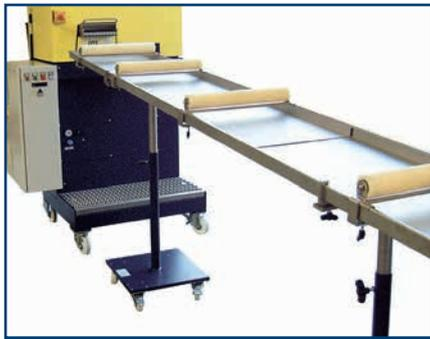
Alimentación de hilos desde el canal de enfriamiento hasta la peletizadora.
