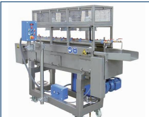
Agua nebulizada (difusor neumático de pulverización de líquido) y refrigeración del flujo de aire (ventiladores de velocidad controlada) con filtrado de polvo
