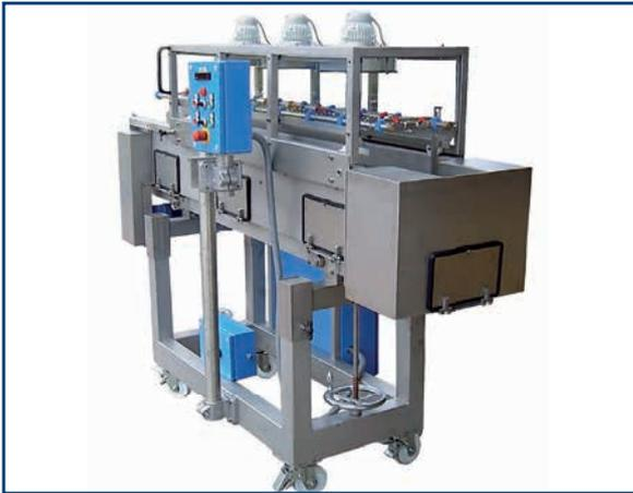
Agua nebulizada (difusor neumático de pulverización de líquido) y refrigeración por flujo de aire (ventiladores con control de velocidad)
