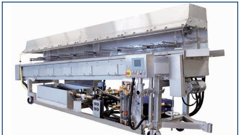
Agua nebulizada (difusor neumático de pulverización de líquido) y refrigeración del flujo de aire (ventiladores con control de velocidad), con sistema de agua de proceso integrado, carcasa y panel de operación confortable
