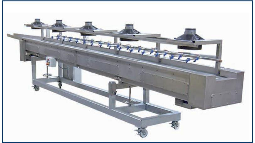
Sin carcasa: refrigeración por agua pulverizada y flujo de aire (ventiladores con control de velocidad)
