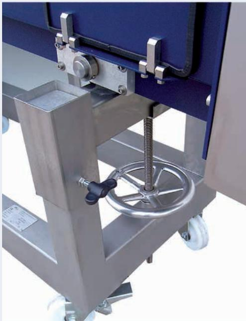
Instalaciones de ajuste de altura independientes, montadas tanto en el cabezal de la matriz de hilo como en el lado del pelletizador del subchasis de la máquina.
