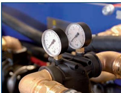
Sistema de agua de proceso integrado en el subchasis de la máquina
