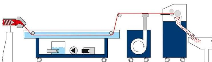
Pelletización de hebra convencional, proceso de corte en seco
