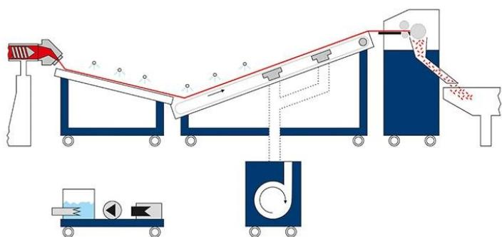
Sistemas de pelletización de hebra automatizados, proceso de corte en seco
