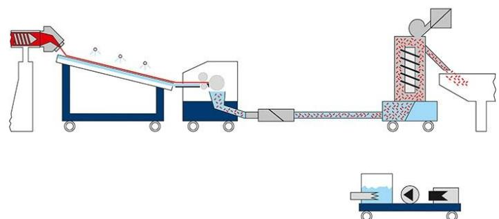
Sistemas de pelletización de hebra automatizados, proceso de corte húmedo.
