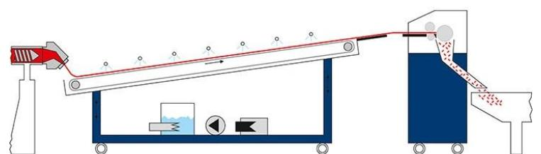
Pelletización convencional de filamentos con transportador, proceso de corte en seco
