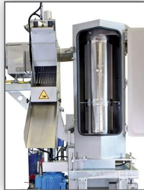
Colector de aglomerados con válvula de compuerta accionada neumáticamente (sellado sin material) y expulsión automática (*opcional*)
