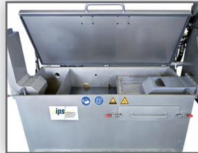
Depósito de agua de proceso con filtro de cajón integrado.
