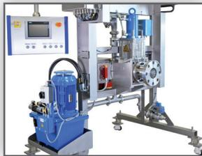
Válvula desviadora de polímero y unidad hidráulica integrada en el bastidor de la máquina.
